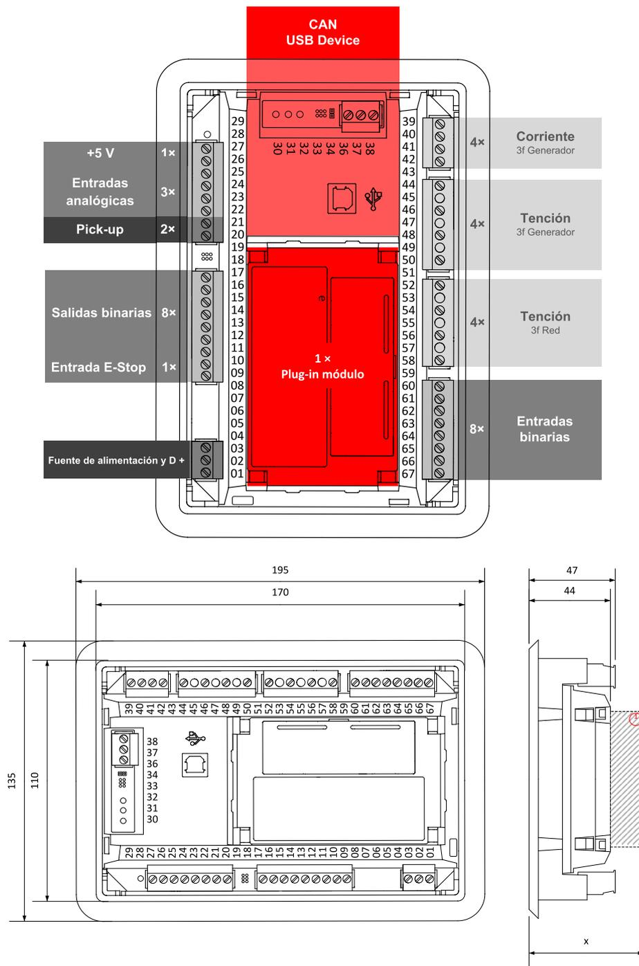
**Nota:** La profundidad final del controlador depende del modulo de extensión instalado – puede variar entre 41 mm y 56 mm. Tomar en consideración el tamaño de los conectores y cables (P.ej. En caso de conectores RS232, añadir unos 60 mm para conectores y cables standard).
